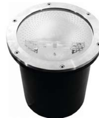
GRAN 100 RX 7S, prečnik 250mm, visina 292mm, boja prstena saten/hrom, boja tela crna, materijal aluminijum/staklo IP67
