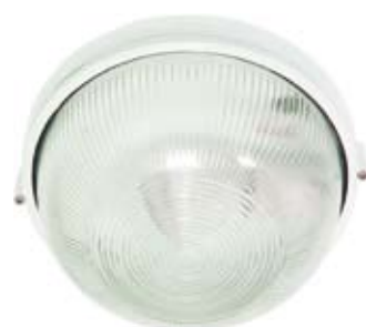
SAN 100 E 27, prečnik 245mm, visina 120mm, boja bela materijal aluminijum/staklo IP54
