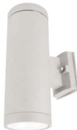
REGOLA 260 2xE 27, dimenzije 290x175, prečnik 100, boja siva, materijal aluminijum/staklo IP54
