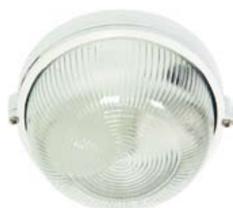
SAN 60 E 27, prečnik 180mm, visina 100mm, boja bela materijal aluminijum/staklo IP54
